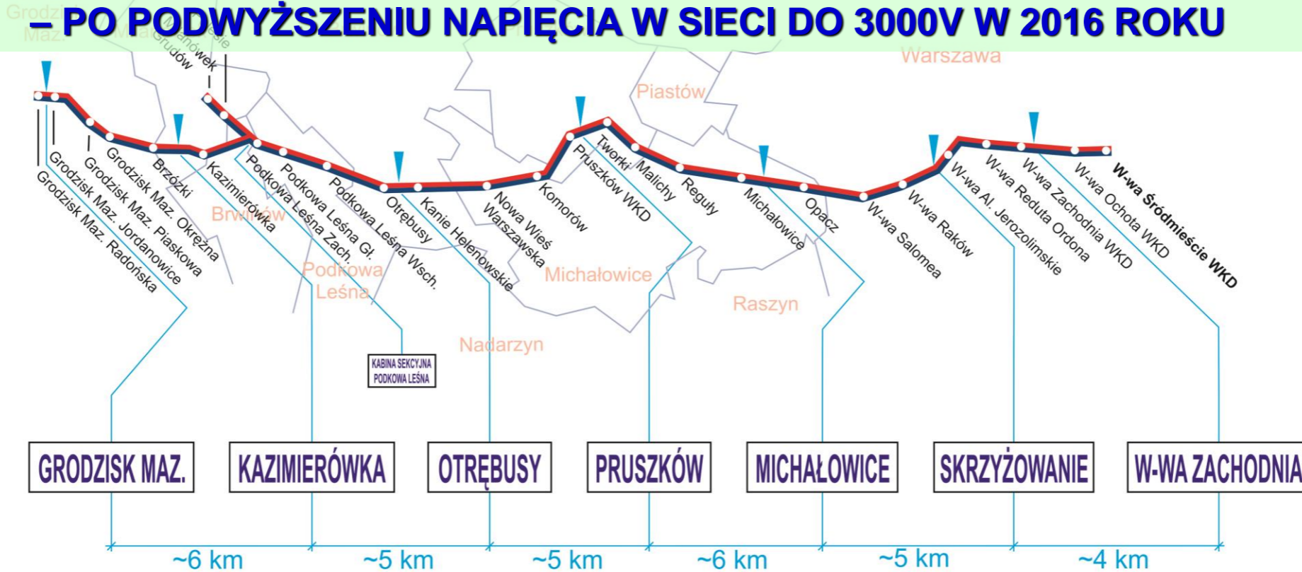
UKŁAD PODSTACJI TRAKCYJNYCH PO ZMIANIE NAPIĘCIA ZASILANIA NA 3000V:
